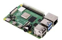
Fig. 4: Raspberry Pi 4 Model B
